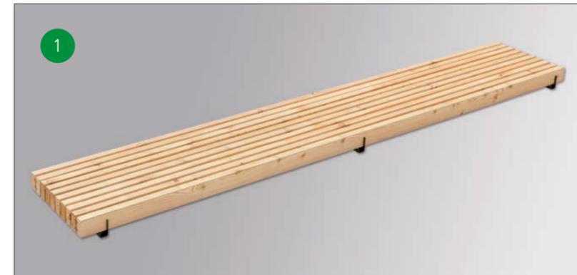
Jedes Modul besteht aus zehn Profilen, die durch Rechen verbunden zu einer verlegefertigen Einheit montiert sind. So entsteht bei Längen von 2 m bzw. 4 m eine Breite von 330 mm pro Modul.
