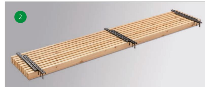
Zur Erzielung individueller Breitenmaße können zusätzliche Profile montiert werden. Dazu einfach weitere Rechen Pinutex R10 (3 Stück bei 2 m Länge bzw. 5 Stück bei 4 m Länge) mit Überstand befestigen.
