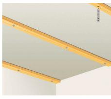
**01** Pour la fixation des profilés en bois massif, visser des lattes qui serviront d'ossature. Compenser les inégalités éventuelles du plafond/mur à l'aide de cales. Distance maximale entre les lattes : 50 à 60 cm !
