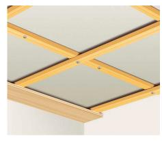
03 Fixer la première lame de profilé en bois massif sur l'ossature au moyen de fines pointes en acier (languette côté mur), en veillant à ce que son orientation soit parfaite. Laisser un joint de dilatation entre le mur et la première lame de 10 à 15 mm.
