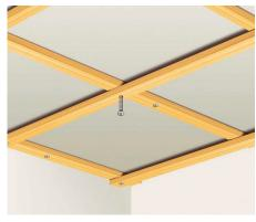
02 En locaux à milieu humide l'air doit circuler librement sous les profilés, et ceci en deux sens. C'est pourquoi on procèdera à un contre-lattage, vissé perpendiculairement à l'ossature de base. Bien entendu, vous tiendrez compte du fait que cela modifiera le sens de pose de vos profilés.
