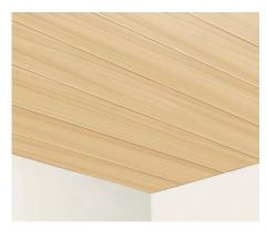
05 Pour une finition parfaite du plafond, garder une distance de 10 à 15 mm du mur en sciant la dernière lame sur toute sa longueur. Facultativement une baguette de finition peut être posée. Les conseils de pose cidessus sont le résultat de notre longue expérience. Il ne saurait en découler une quelconque revendication juridique.
