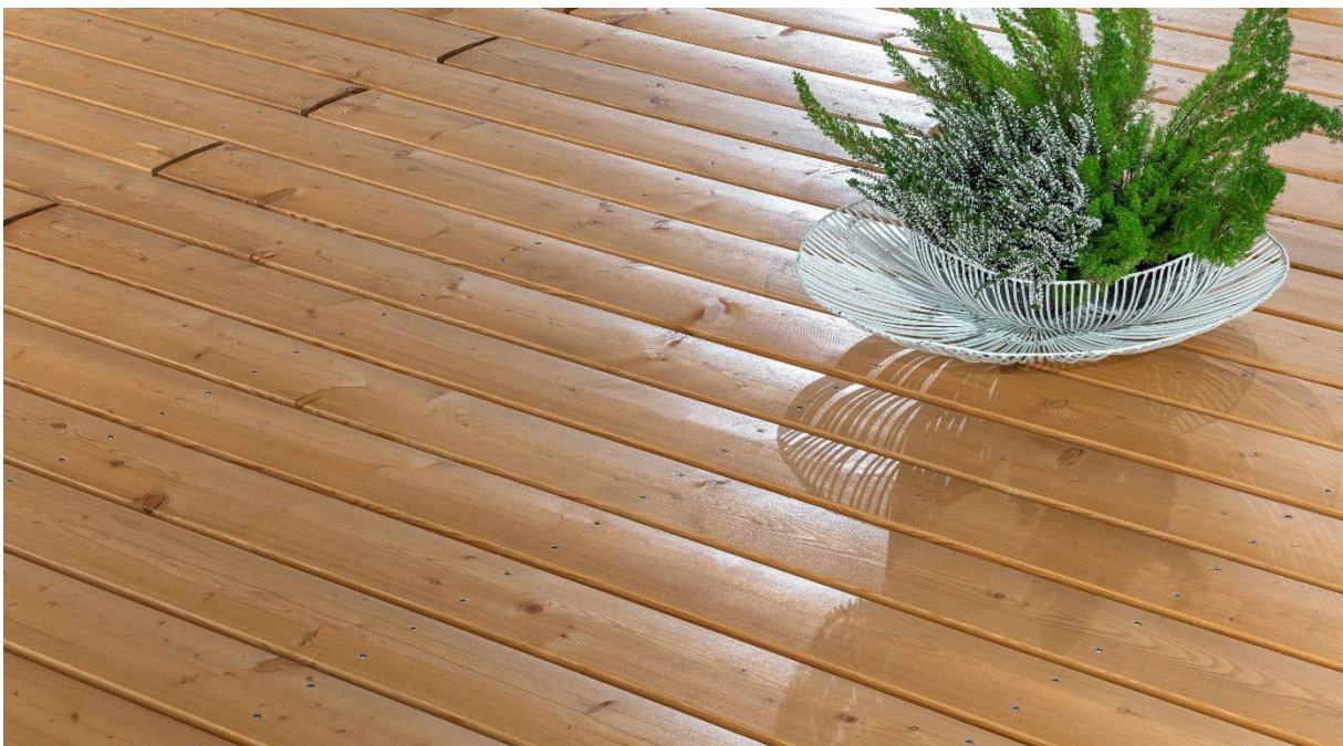
BU: Die Oberflächen der Vollholzprofile X-TRA APEXLINE 10 sind leicht gewölbt, dadurch läuft Wasser gut ab und eine Pfützenbildung wird verhindert. Zudem sorgt diese Profilform für ein Wohlgefühl beim Begehen.
