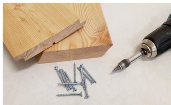
1. Pour l'assemblage des pièces, utilisez des vis en acier inoxydable de 5 x 60 mm (filetage partiel) avec pointe de forage et nervure de fraisage.
