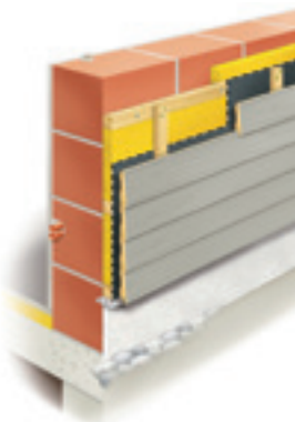
Structure d'un mur en construction en dur.
