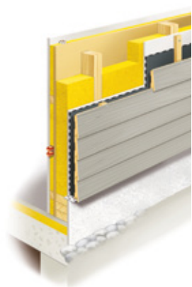
Wandaufbau der Holzskelettbauweise.
