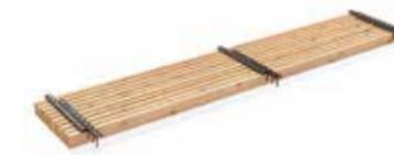
Zur Erzielung individueller Breitenmaße können zusätzliche Profile montiert werden. Dazu einfach weitere Rechen Pinutex R10 (3 Stück bei 2 m Länge bzw. 5 Stück bei 4 m Länge) mit Überstand befestigen.
