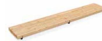
Jedes Modul besteht aus zehn Profilen, die durch Rechen verbunden zu einer verlegfertigen Einheit montiert sind. So entsteht bei Längen von 2 m bzw. 4 m eine Breite von 330 mm pro Modul.
