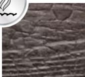
**Surface carbonisée :** La combustion contrôlée des surfaces en bois crée un parement carbonisé qui offre une multitude d'aspects selon les structures et le grain des bois.
