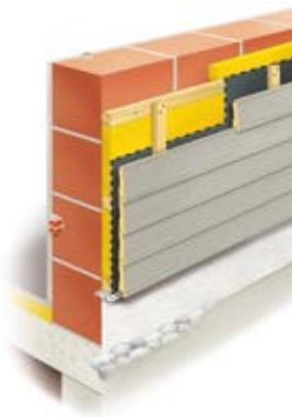
Structure d'un mur en construction en dur.
