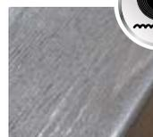
**Surface micro-striée :** Des fers de rabot finement dentelés créent une surface micro-striée qui permet une meilleure tenue de la finition et un effet irisé des surfaces.
