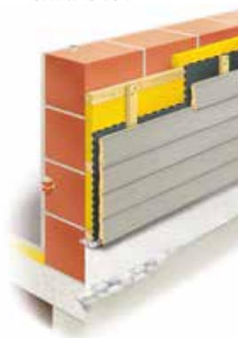
Structure d'un mur en construction à ossature bois.
