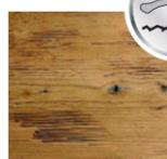
**Surface éclatée :** Rabotée au préalable, la surface est alors lentement travaillée à l'aide de multiples couteaux, lentement et tout en surface. Ce principe s'apparente au traitement ancestral appliqué jadis pour équarrir les poutres, il confère au bois un caractère rustique bien particulier.
