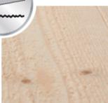
**Scié fin :** Le bois refendu à la scie à ruban présente une surface brute de sciage. Par un procédé de brossage répété et minutieux, les fibres de bois détachées sont partiellement éliminées pour garantir une qualité optimale de la surface des profilés, cela afin d'offrir le meilleur support à toute finition.
