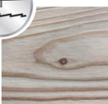
**Surface brossée :** La surface préalablement rabotée est travaillée de manière intensive à l'aide de brosses. Les bois tendres comme l'épicéa possèdent des cernes de croissance tendres et durs qui se creusent en fonction de la dureté du bois lors du brossage, on obtient une surface « ondulée » accentuant bien la structure du bois.
