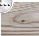
**Surface brossée :** La surface préalablement rabotée est travaillée de manière intensive à l'aide de brosses. Les bois tendres comme l'épicéa possèdent des cernes de croissance tendres et durs qui se creusent en fonction de la dureté du bois lors du brossage, on obtient une surface « ondulée » accentuant bien la structure du bois.
