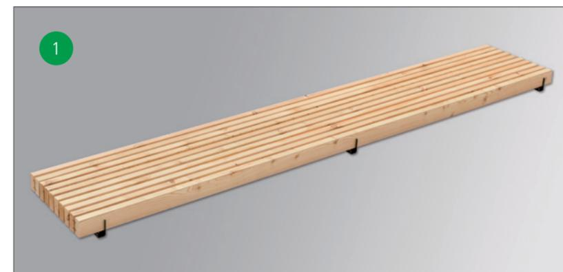
Chaque module est composé de 10 profilés. L'assemblage se fait à l'aide de rails de connexion. Les modules prêts à poser ont une largeur de 330 mm et une longueur de 2,00 ou 4,00 mètres au choix.
