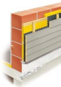
Structure d'un mur en construction en dur.
